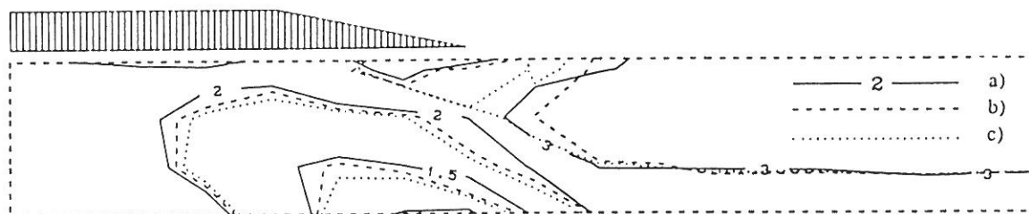
Slika 13. Izolinije količnikov varnosti v temeljnih tleh za tri različne primere: a) nearmirano površje, b) armirano z 1 plastično mrežo na površju tal, c) 2 plastični mreži na površju.
